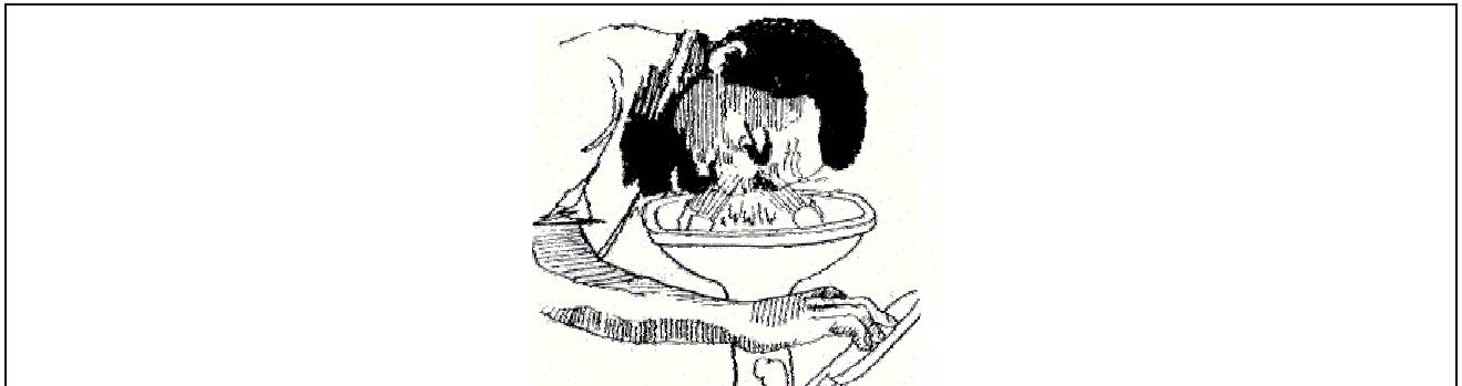
Hình 55: Lắp đặt vòi cấp cứu, những bồn rửa mặt ở gần vị trí có sử dụng hóa chất.
